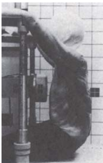
Rys. 1. Stanowisko Kroella i in. [3] do badań na zwłokach ludzkich Fig. 1. Kroell et al. [3] experimental rig
